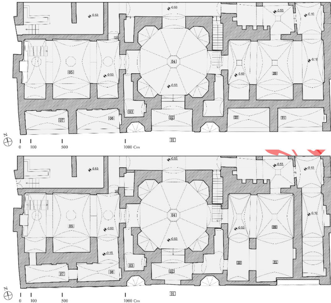
شکل ۲۴. نقشه تغییرات ساختاری فضای ۰۶-۰۷ در قسمت غربی هشتی ورودی و تغییرات فضای ۲۱-۲۲ در قسمت شرقی جبهه جنوبی (بالا) نقشه فرضی اولیه قبل از تغییرات (پایین) نقشه وضع موجود بعد از مسدود شدن طاق نما (منبع: نگارندگان)
